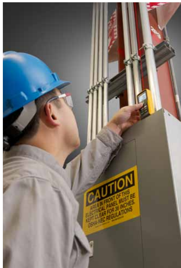
Medição da altura a tectos altos.
