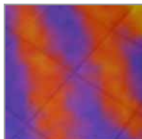
Inspecção do piso radiante hidráulico
